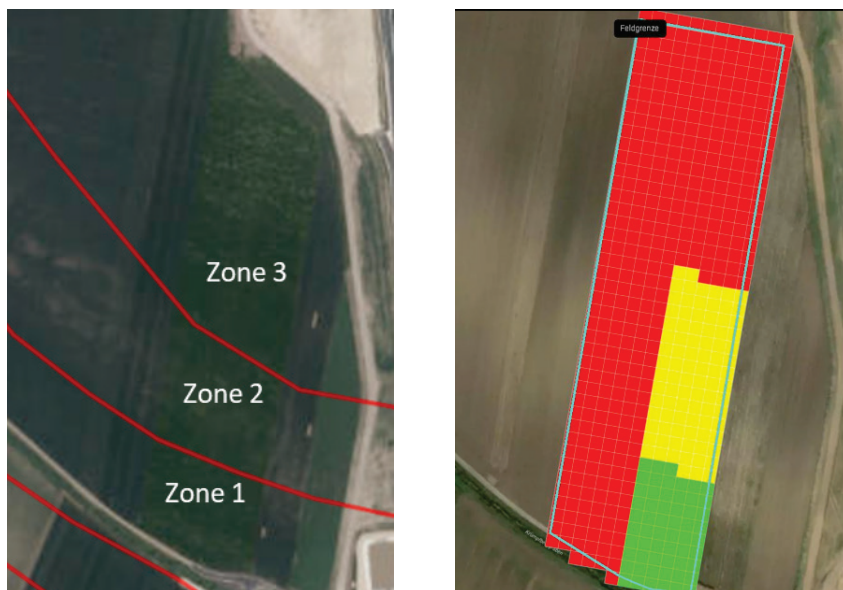
Abbildung 1: Vergleich variabler und konstanter Düngung auf einem Feldstück mit unterschiedlicher Bodenbeschaffenheit ( Bild links : Bodenkarte aus e-bod; Zone 1 – Tschernosemkolluvium (Ertragskraft hoch), Zone 2 – Kulturrehoboden (Ertragskraft niedrig), Zone 3 - Tschernosem (Ertragskraft mittel) Bild rechts : Düngekarte gemäß Bodenzonierung im differenziert gedüngten Streifen)
