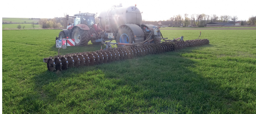
Bild 3: Spornräder des Dupot Liquilisers zur „Injektion“ der Ammoniumlösung
