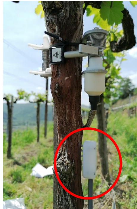
Abbildung 4: Links: Einbau Metallhülsen, Rinde geschält. Rechts: fertig installierter Saftflusssensor.
