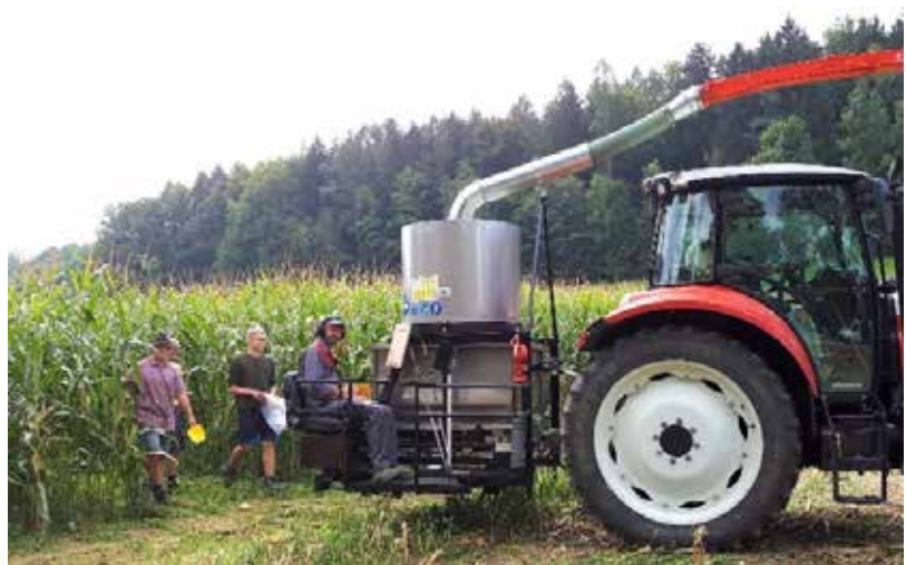
Vor der Ernte wird von jeder Parzelle die Pflanzenzahl sowie die Wuchshöhe ermittelt. Danach folgt der 2-reihige Spezial-Parzellenhäcksler der LAKO mit Wiegeeinrichtung und die Probenziehung.
