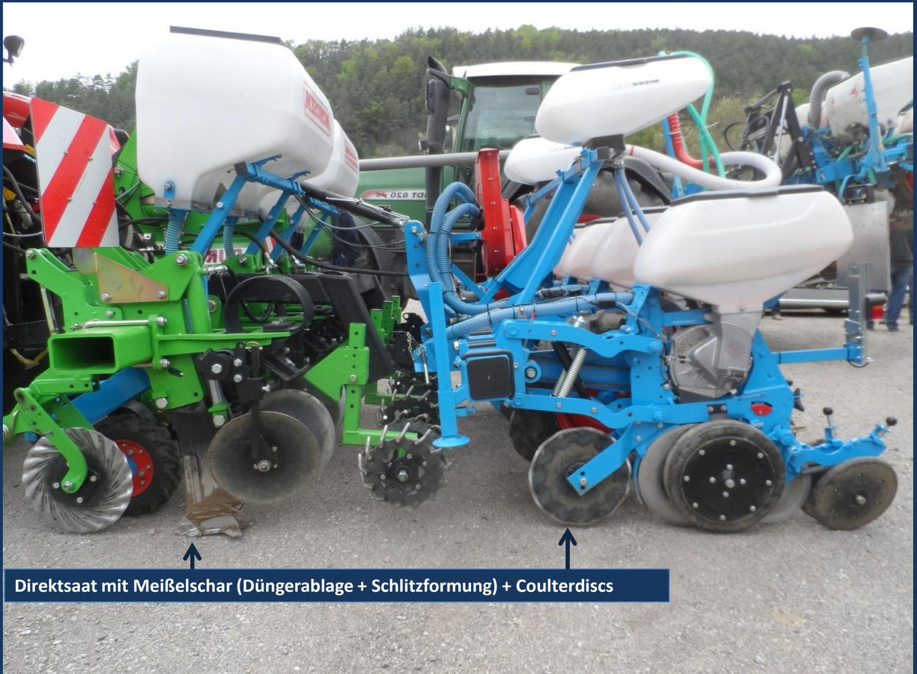
Direktsaat mit Meißelschar (Düngerablage + Schlitzformung) + Coulterdiscs
