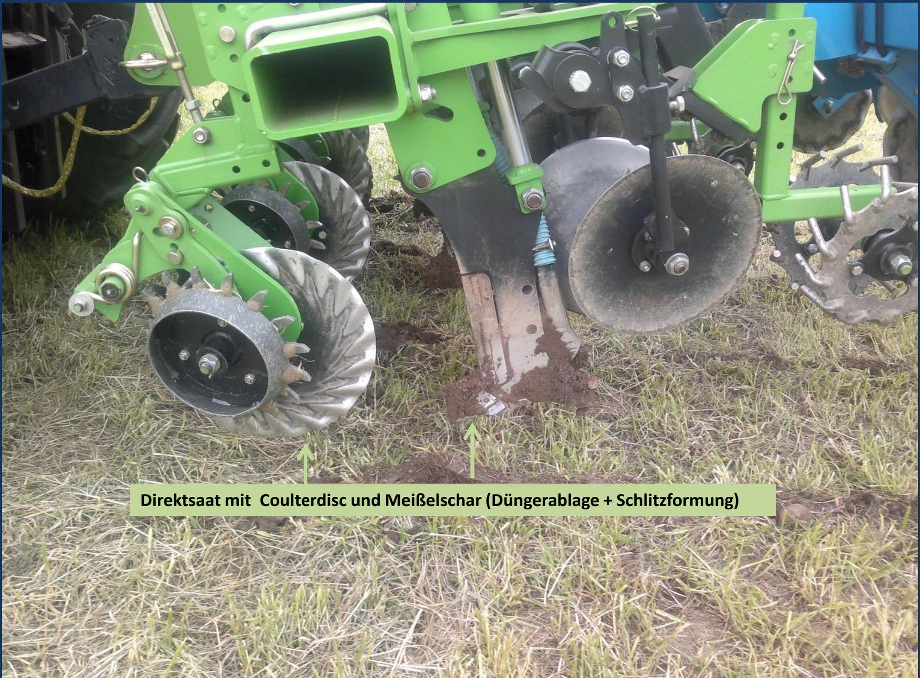
**Direktsaat mit Coulterdisc und Meißelschar (Düngerablage + Schlitzformung)**
