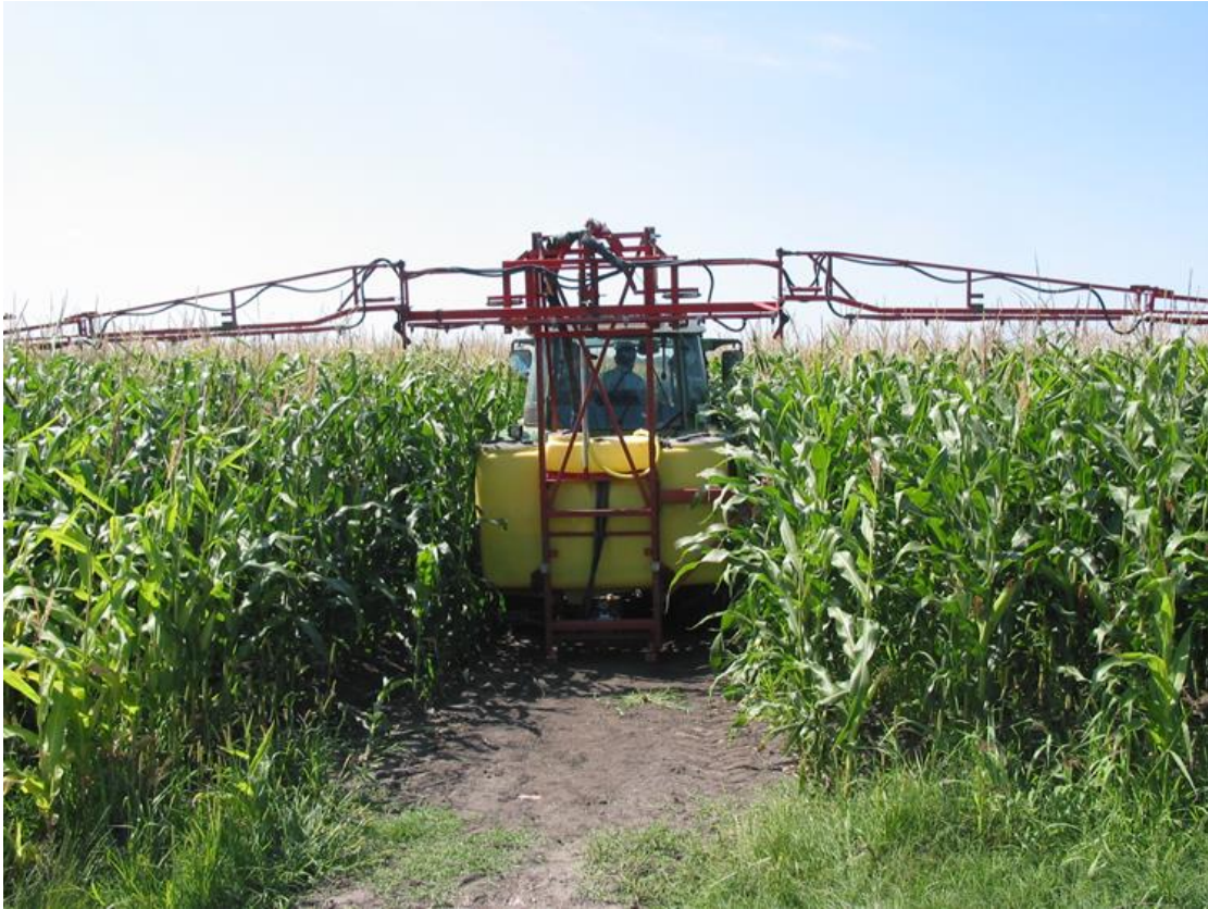
Abb. 3: adaptierte Feldspritze mit 3 m hohem Spritzbalken
