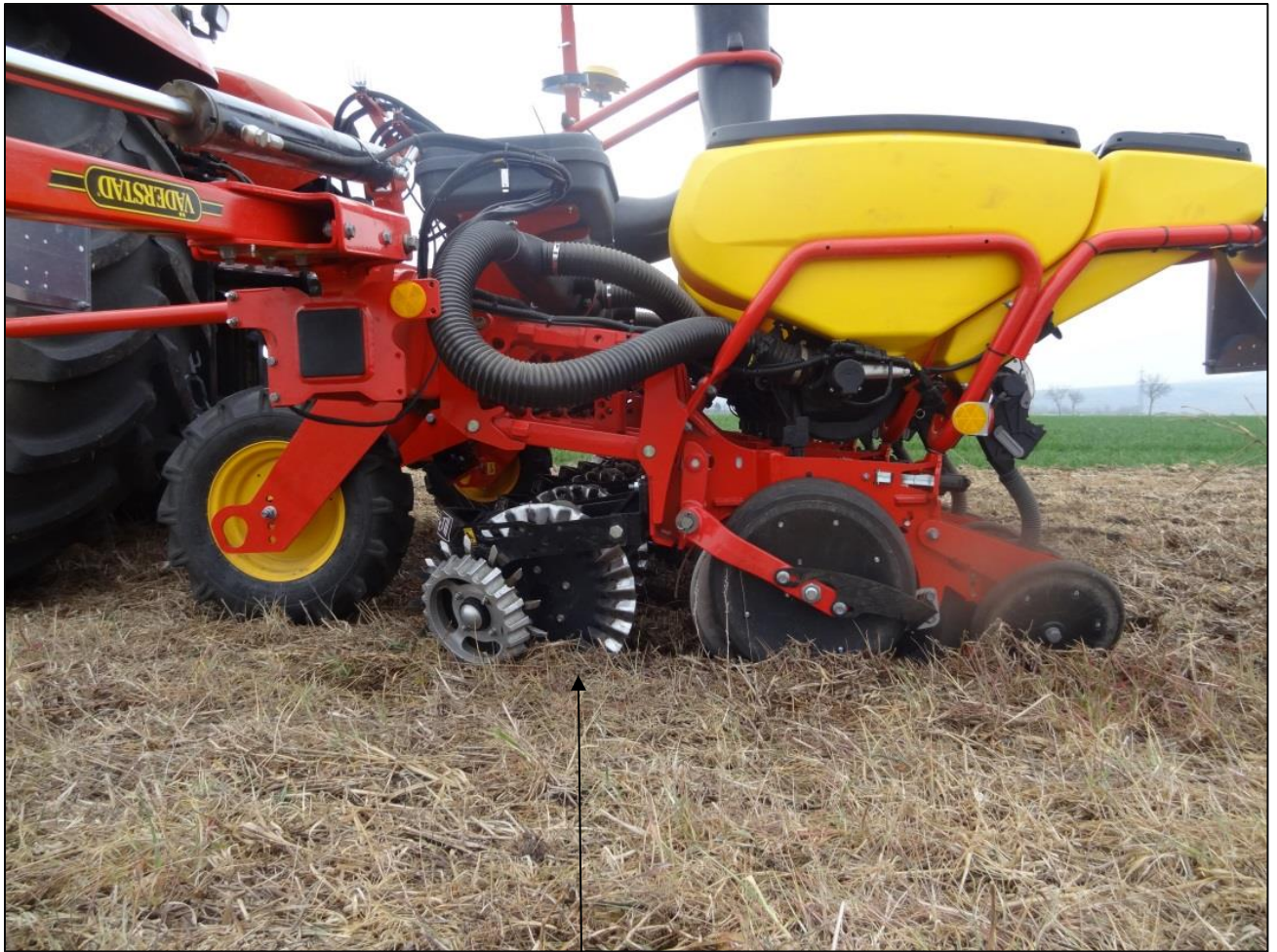
Einzelkornsämaschine für Direktsaat mit Wellscheibenvorsatz (Coulter Discs)
