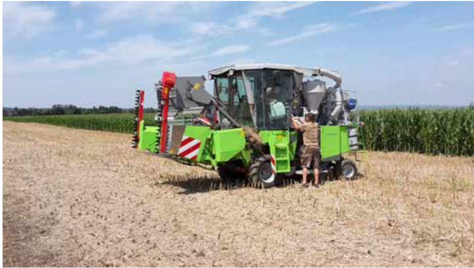
Die Ernte der Parzellen erfolgte mit dem LAKO - Parzellenmährescher mit Seitenschneidwerk
