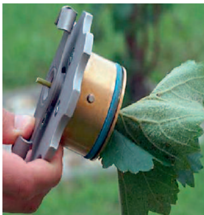
Abb. 1: Eingespanntes Reblatt – die Blattspreite wird anschließend in die Druckkammer transferiert
