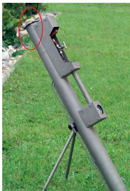
Abb. 2: Transportables Messgerät mit rot gekennzeichnete Druckkammer und darunter liegendem Druckvorratsbehälter
